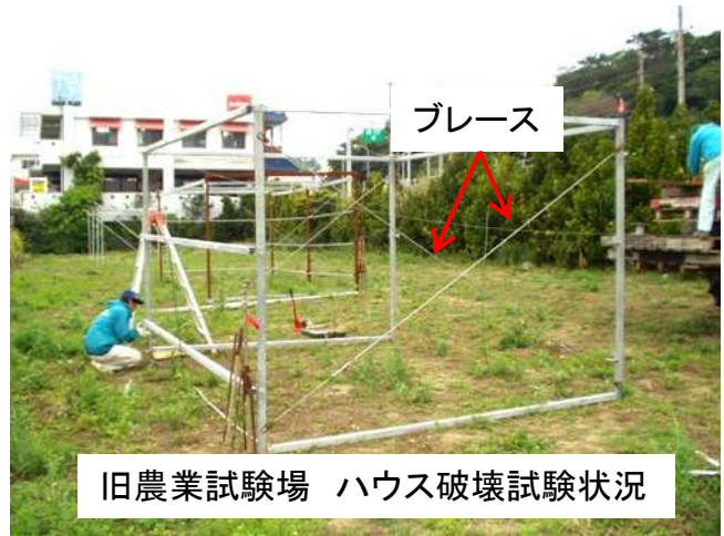
ブレース(筋かい)による補強は効果抜群
